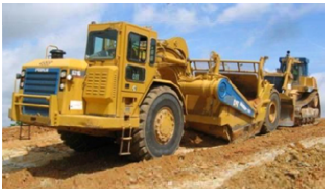
Figure 9 : Scrapper 631 en cours de décapage.
