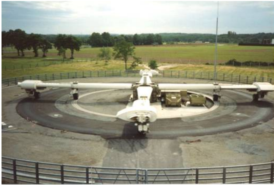
Figure 8. Le manège de Fatigue du LCPC, vue d'ensemble
