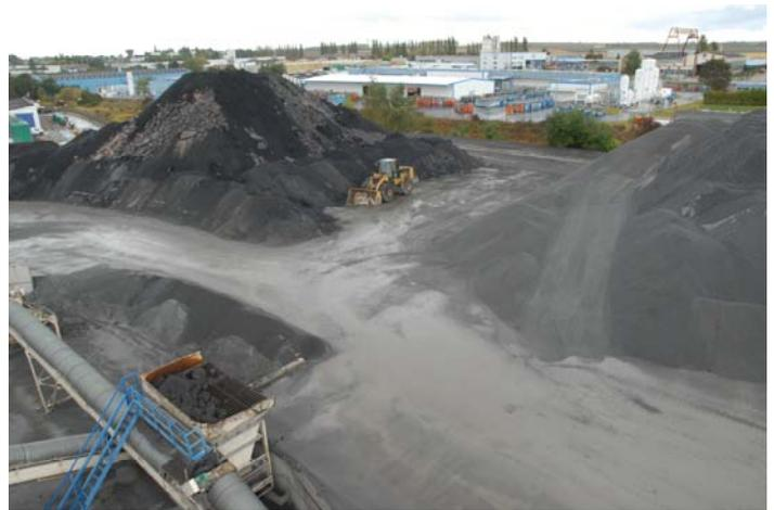
**Figure 4** : Reprise par pelle mécanique avant concassage
