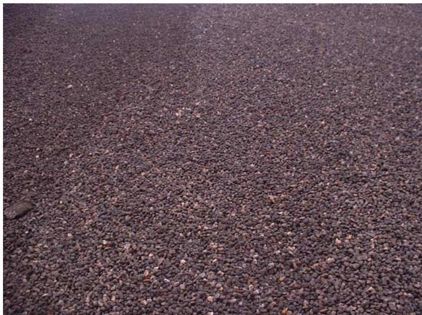
**Figure 6** : Stock de refus au criblage à 12,5 mm
