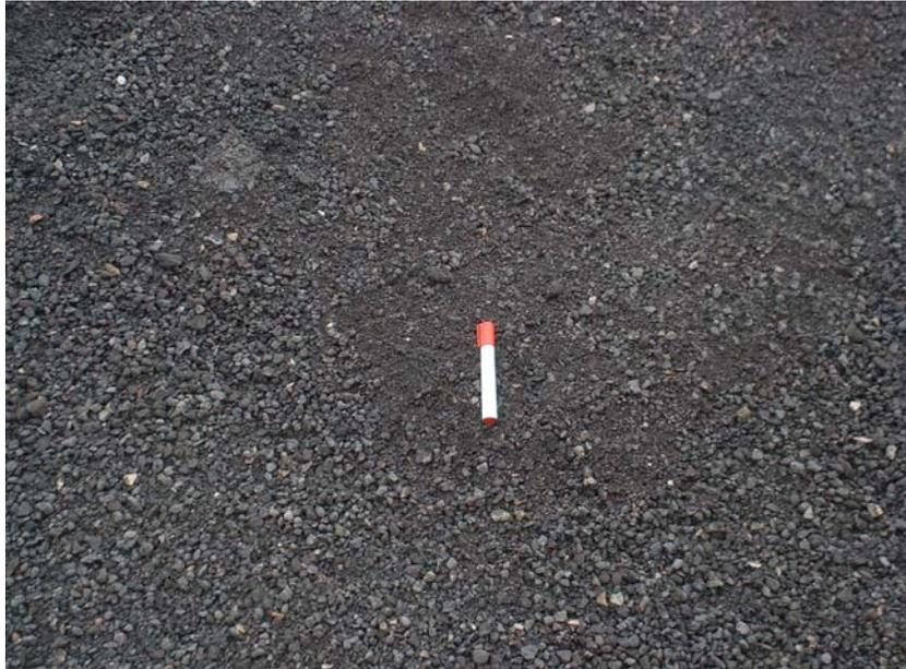
**Figure 5** : Stock d'agrégats 0/10mm après concassage – criblage
