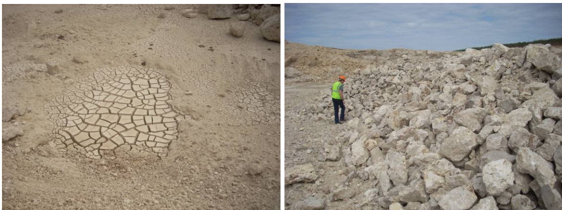
Figure 15: dépôts de fines (à gauche) au pied d'un stock de blocs (à droite)
