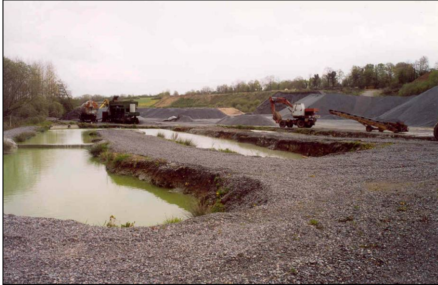
Figure 9 : exemple de bassin de décantation des eaux de lavage des gravillons (LR Blois)
