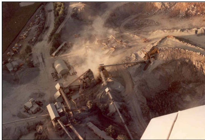
Figure 8 : exemple de panache de poussière généré par une installation de concassage criblage (photo LRPC Blois)
