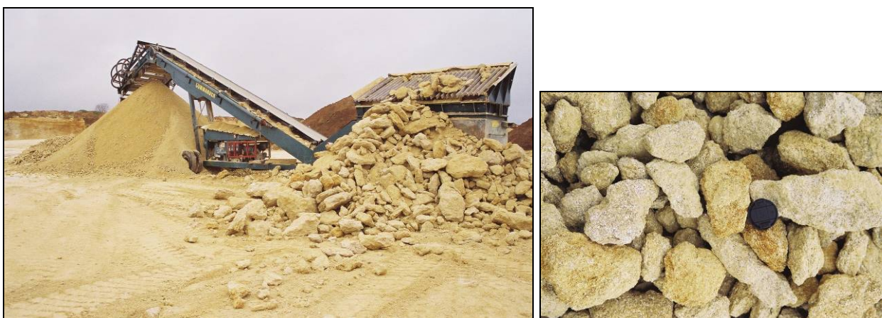
Figure 7 : pré-criblage dans une carrière de falun permettant d'éliminer une fraction 50/D. L'exploitant cherche à valoriser cette fraction pour d'autres usages que celui recherché pour les faluns utilisés comme sable pour remblai de tranché. L'étude de la résistance des blocs permettra d'orienter les solutions de valorisation
