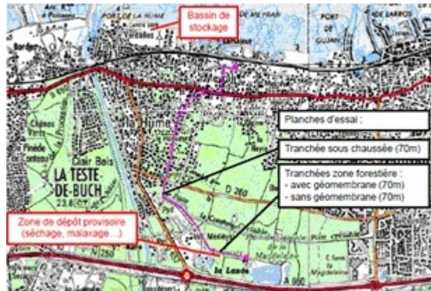
Figure 4 : Localisation du bassin de stockage des sédiments, de la zone de dépôt provisoire et des planches d'essais. (Nedelec et al., 2011).
