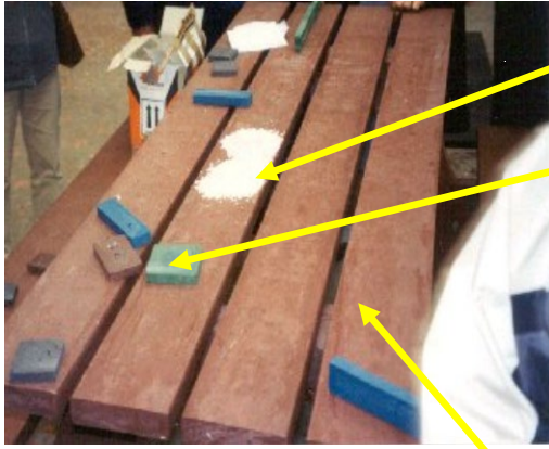
Figure 10 : Quelques exemples - Table de pique-nique colorée réalisée à partir des éléments recyclés par extrusion ; Granulés obtenus ;Echantillons de plastique recyclé colorés dans la masse. (photo : CETE Normandie Centre - 2001- CEERD Région Normandie)
