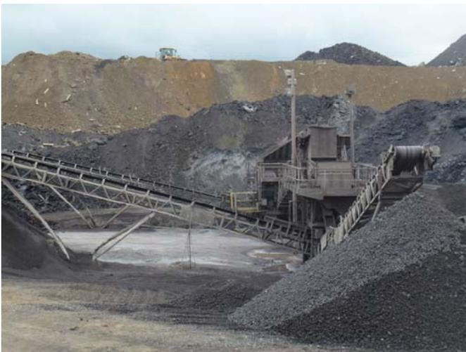
**Figure 6 :** Site d'élaboration des laitiers d'aciérie électrique de LME-Trith (Sources CTPL)
