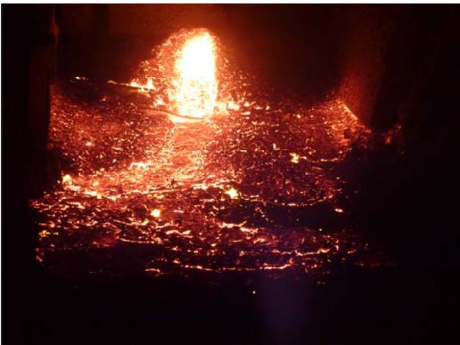
**Figure 4** : Génération d'un laitier d'aciérie électrique, site Ascométal de Fos-sur-Mer (Sources CTPL)
