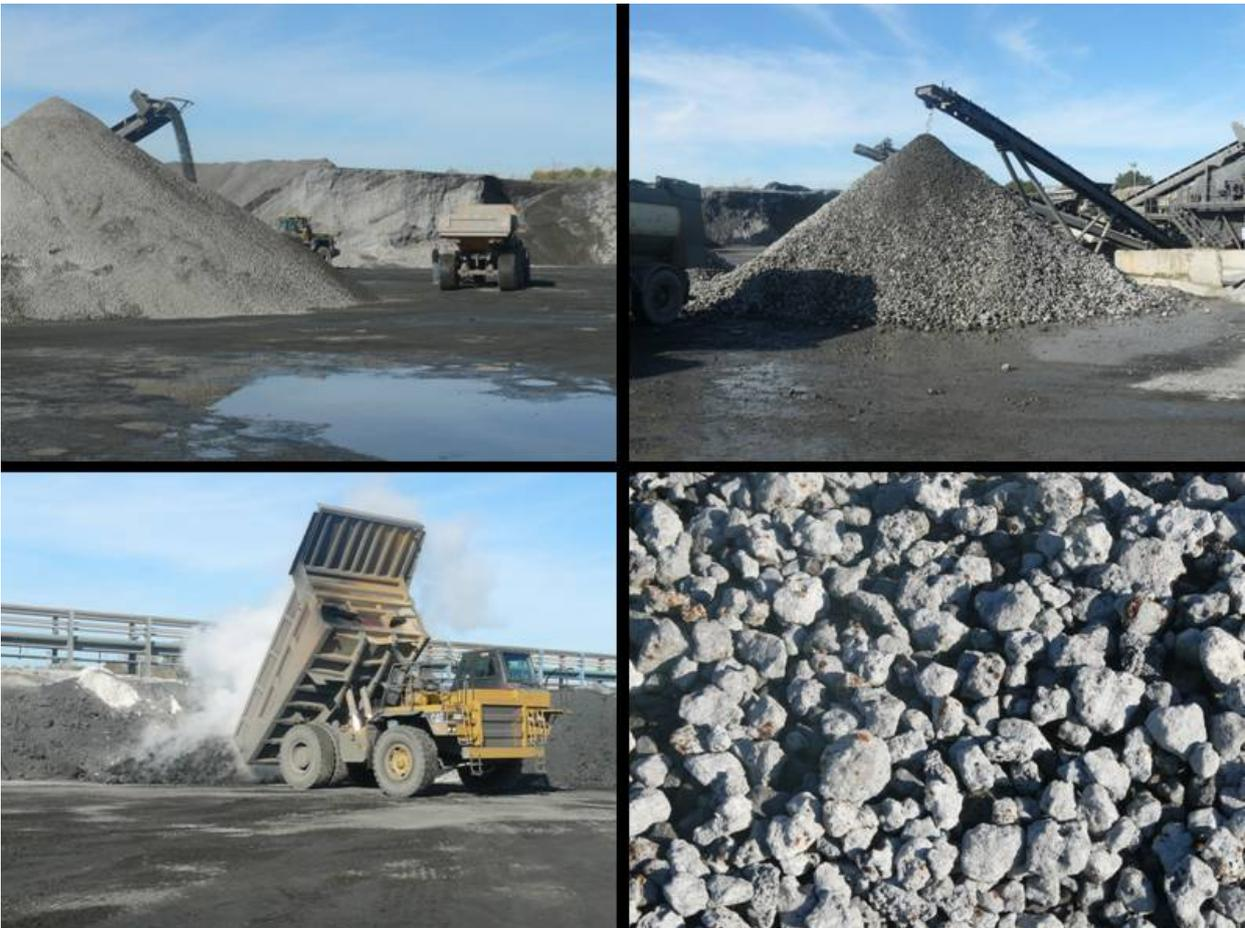
**Figure 9** : Illustrations d'une Centrale de concassage et criblage de laitiers d'aciérie électrique (Source : T.S.V./Durruty, Site de Boucau (64))
