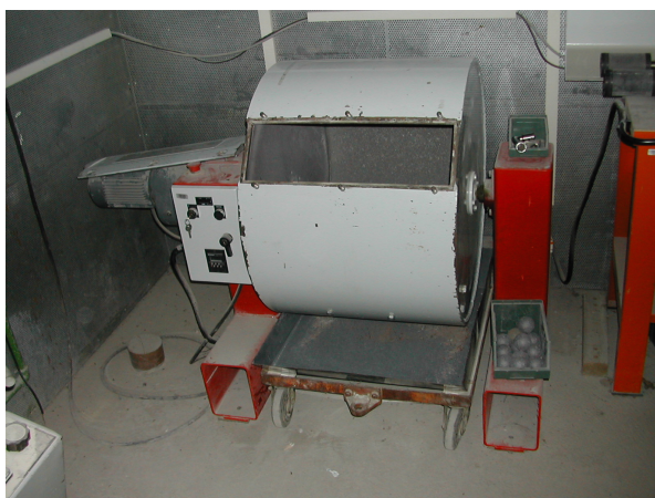
Fig. 1 : Appareil Los-Angeles, essai selon la norme NF EN 1097-2.
