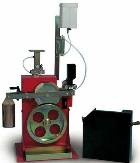
Fig. 3 : Machine PSV® (LINDQVIST INTERNATIONAL).
