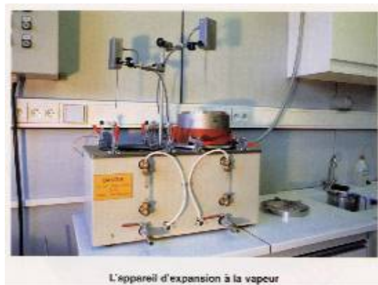
Fig. 5 : Photo de l'appareil d'expansion à la vapeur (source : laitiers sidérurgiques 79).
